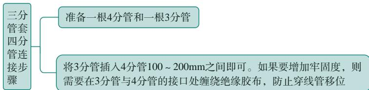
图 6-28 3 分管套 4 分管连接步骤
