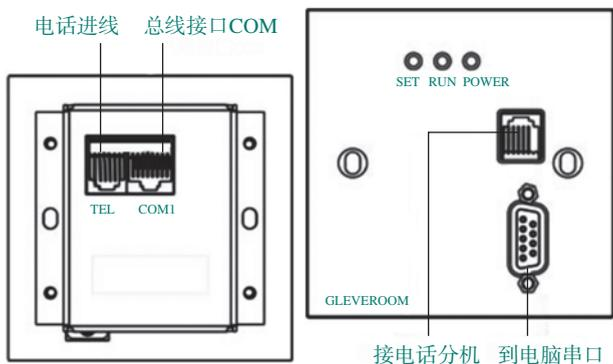
图 7-42 电话远程控制器（墙装式）线路连接示意
