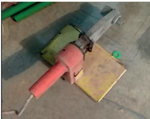
图 2-15 热熔器
