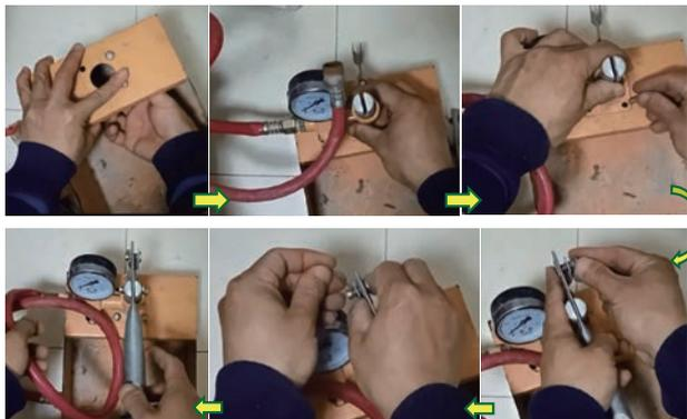
图 2-18 打压泵安装步骤
