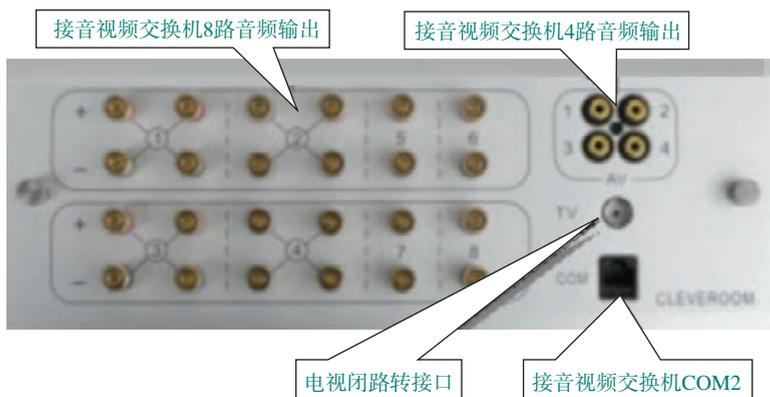
图 7-53 音视频接线盒接线示意
