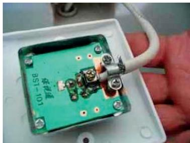
图 7-38 电缆安装
