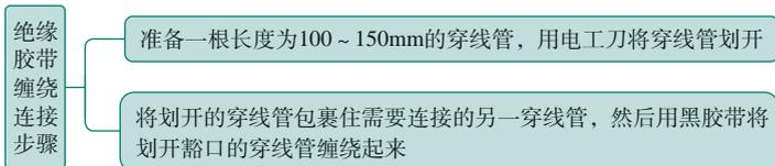
图 6-27 绝缘胶带缠绕连接步骤
