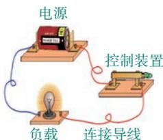
图 1-1 电路的连接方式
