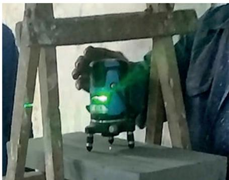
图 6-10 激光水平测量仪
