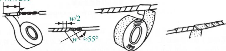
图 6-50 导线直线连接绝缘恢复方法
