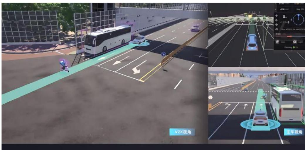
图 2.2 动静态盲区非机动车/行人鬼探头协同感知
