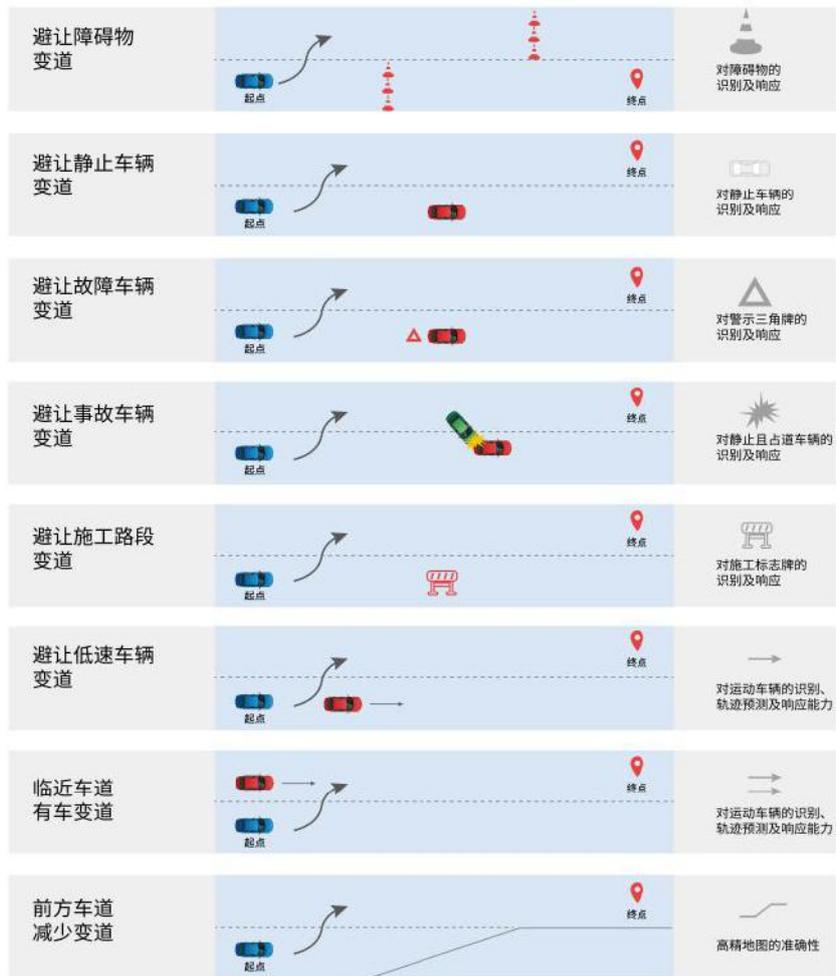
图 2.10 封闭测试场“变更车道”测试场景方案
